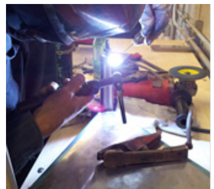
Figura 10. Proceso de soldadura de acero inoxidable
