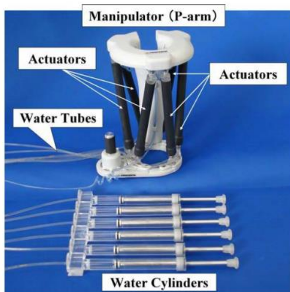
Figura 9. Robot paralelo P-arm utilizado en cirugía laparoscópica (M. Díaz-Rodríguez, 2018)
