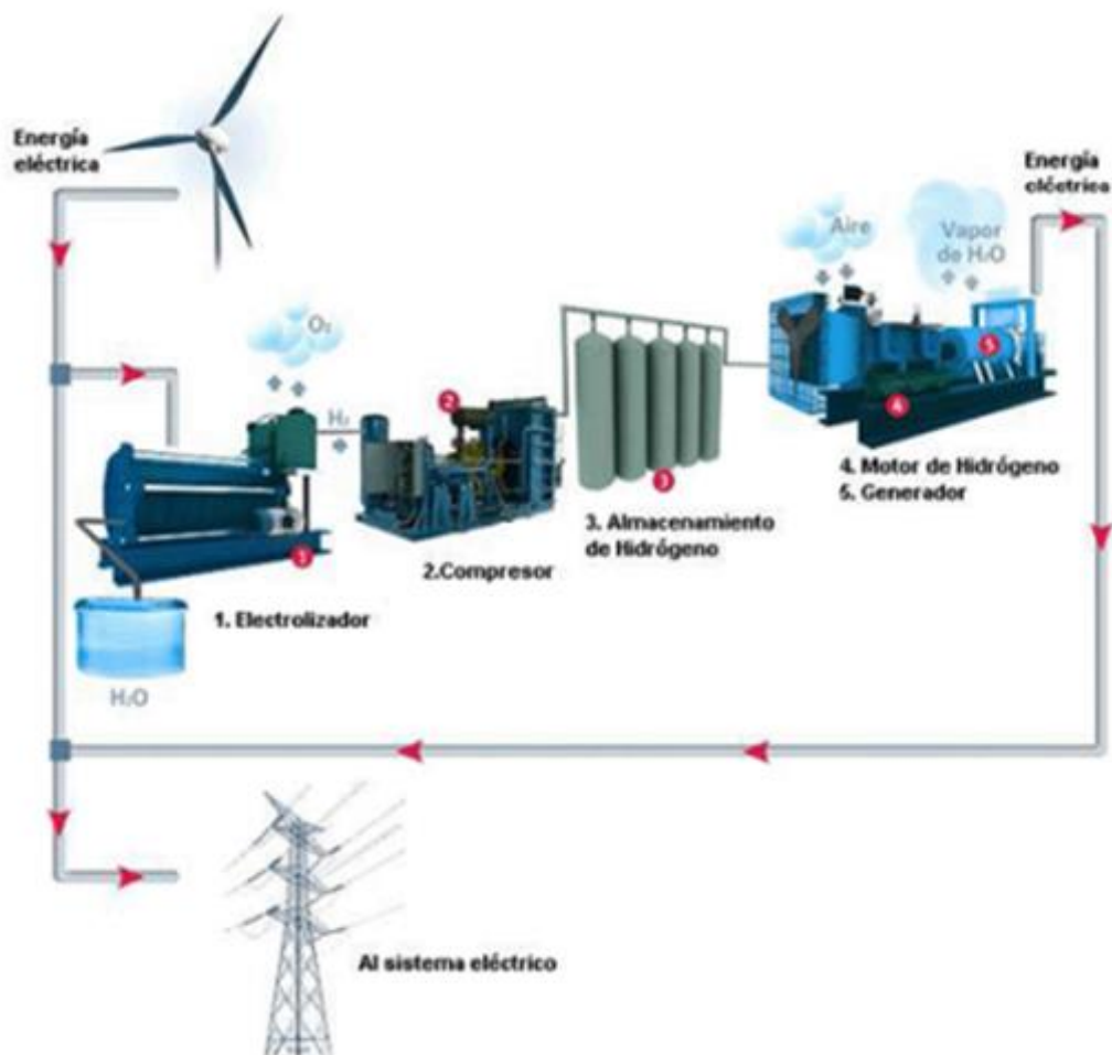
Figura 5. Ejemplo de almacenamiento de hidrógeno a través de un parque eólico (García, 2017).
