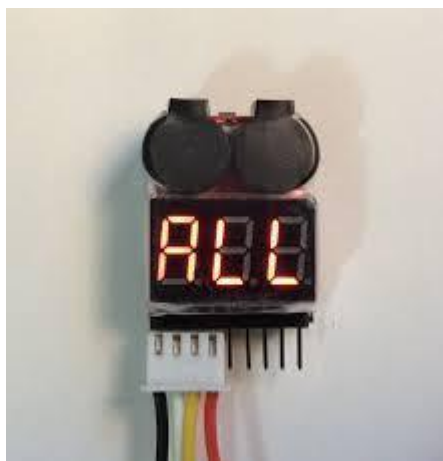
Figura 77-Tester conectado a batería (elaboración propia)
