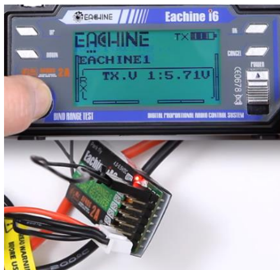
Figura 59-Conexión de jumpers (elaboración propia)
