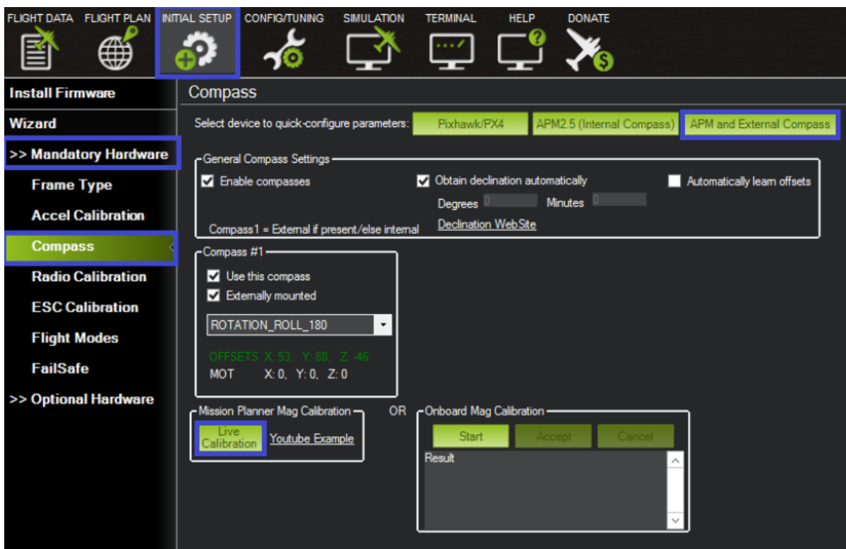
Figura 50-Inicio de calibración GPS (elaboración propia)
