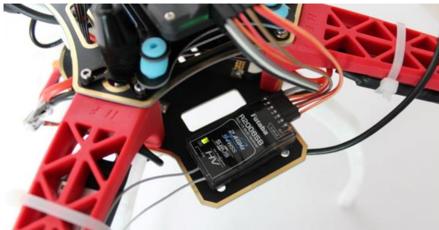
Figura 57-Confirmación de emparejamiento exitoso mediante led en controladora (elaboración propia)
