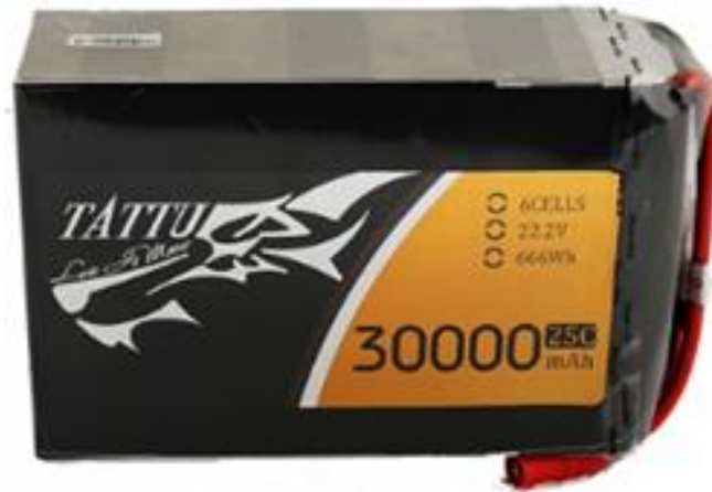
Figura 23 - Ejemplo de características básicas de una batería LiPo (elaboración propia)
