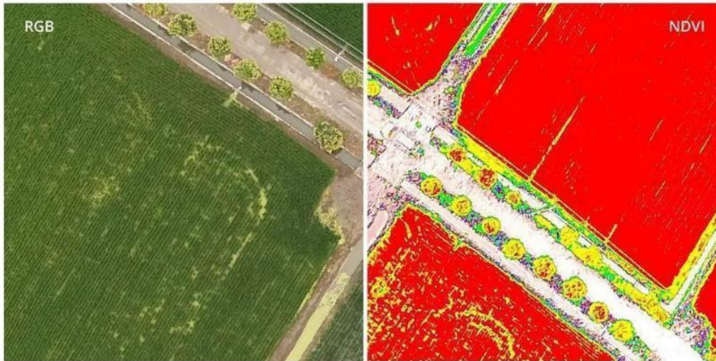
Figura 33 - Diferencia entre sensores RGB y NDVI (elaboración propia)
