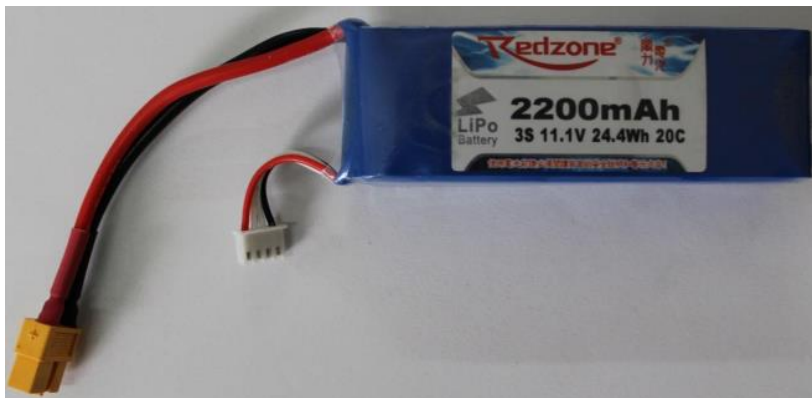
Figura 71-Batería LiPo (elaboración propia)
